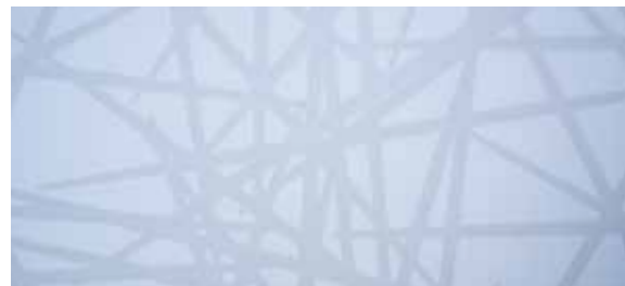
Die UV-reflektierenden Strukturen des Vogelschutzglases sind kaum sichtbar. Die hier zu erkennenden Strukturen konnten nur aus einem sehr spitzen Winkel aufgenommen werden
