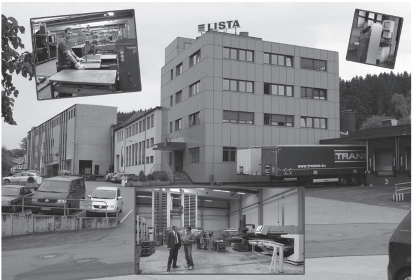
Bild unten: Stanzanlage Trumpf TCR 5000 mit Anbindung an ein STOPA Regalsystem. Bild oben links: Automatische Gehäusefertigung unter Einsatz eines Knickarmschweißroboters der Fa. KUKA. Bild oben rechts: Pulverbeschichtung - mittels Power & Free Anlage werden die Produkte zu den einzelnen Bearbeitungsstufen transportiert.
